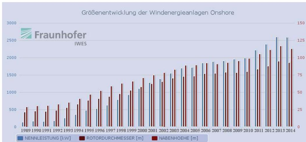
Abbildung 1.2: Größen- und Leistungsentwicklung der Windenergieanlagen. Quelle: [WINDMONITOR]
