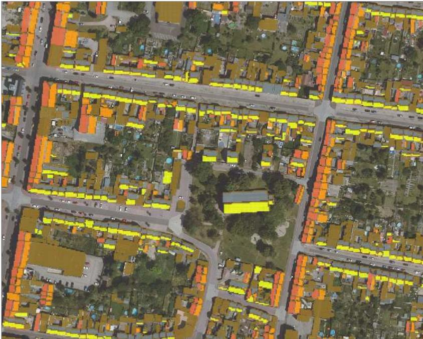
Ertrag in % in Abhängigkeit von Dachneigung und Ausrichtung
